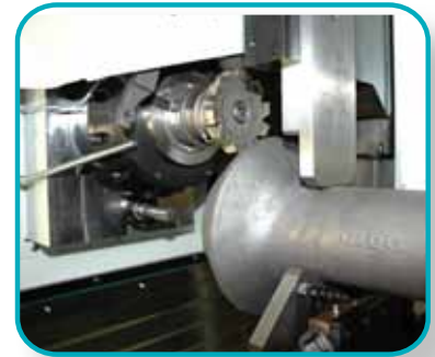
工件夹紧装置，中心工作，可选 3 点或 4 点夹紧。
