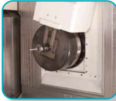
计算机数控镗车头带电子平衡装置。
